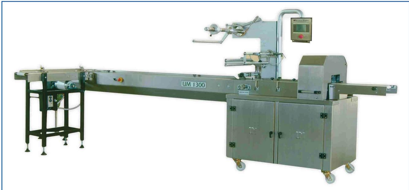
Горизонтально упаковочная машина предназначена для упаковки высоких и узких продуктов различных размеров.
